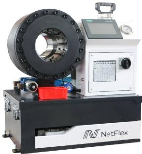
Обжимной станок NFP 7 Kit предназначен для предприятий, специализирующихся на изготовлении РВД, производителей тяжелого оборудования и для ремонтных мастерских, обслуживающих крупный парк техники.
