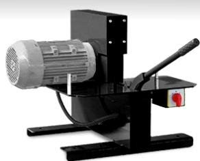
Компактный отрезной станок NFT 4 Kit – хорошее решение для ремонтных мастерских или для небольших предприятий, специализирующихся на изготовлении РВД.
