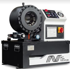
Обжимной станок NFP 6 Kit предназначен для предприятий, специализирующихся на изготовлении РВД, производителей тяжелого оборудования и для ремонтных мастерских, обслуживающих крупный парк техники.
