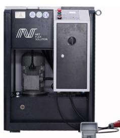
Станок для обжима гаек NFC80 дополнит ваши производственные мощности возможностью изготовления фитингов с предварительно обжатой гайкой.
