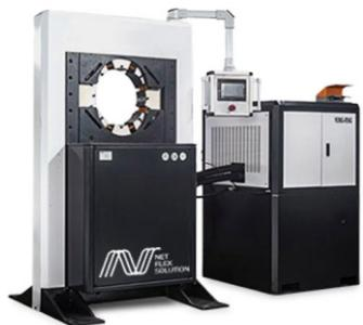
Обжимной станок NFP 10 Kit дополнит ваши производственные мощности станком для рукавов больших и сверхбольших диаметров.
